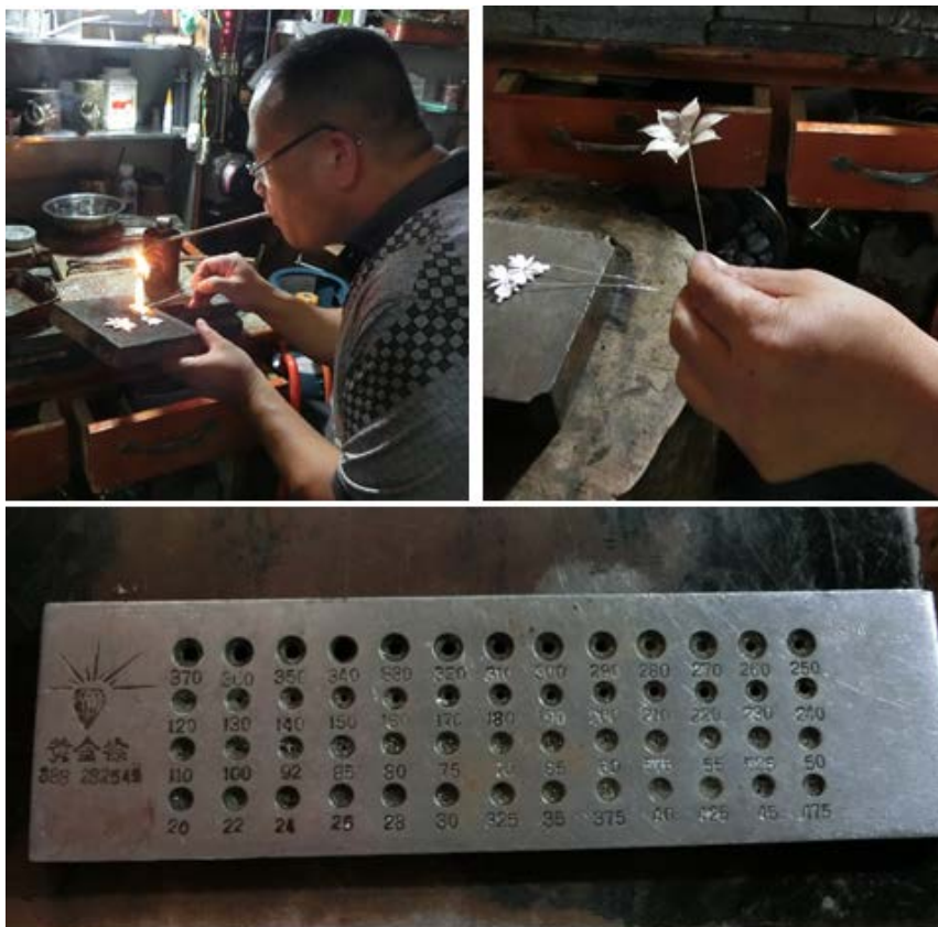
写真4 銀の花飾りの製作工程（上）と銀糸を作る道具（下）。
