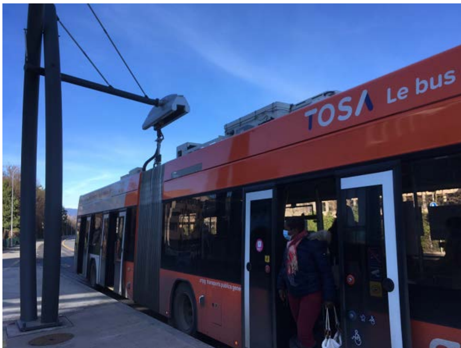
写真1 高速で充電を行う電動バス。バスから充電部分が伸びてきてバス停にある充電施設と連結する。
