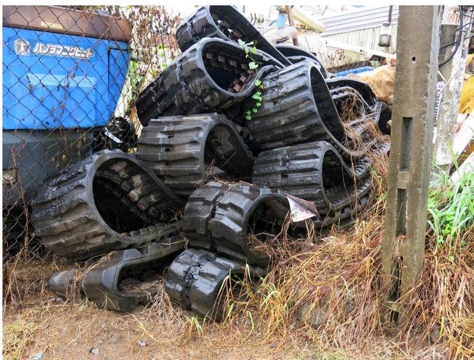
写真3 使用済みクローラー。コンバインの作業時間が長いいためクローラーの消耗も激しく、 頻繁に交換される（ロンアン省タイアン市、2017年8月）。
