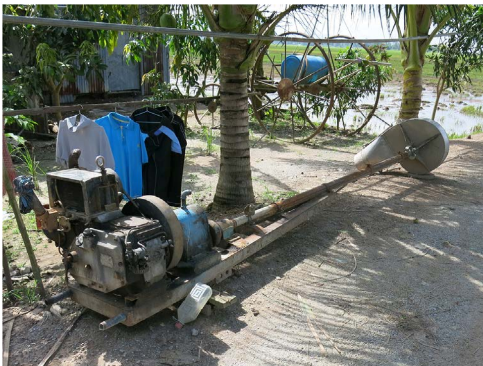
写真2 運河から水田に水を引く灌漑ポンプ。耕耘機のエンジンが使われている (アンザン省トアイソン県、2017年8月)。
