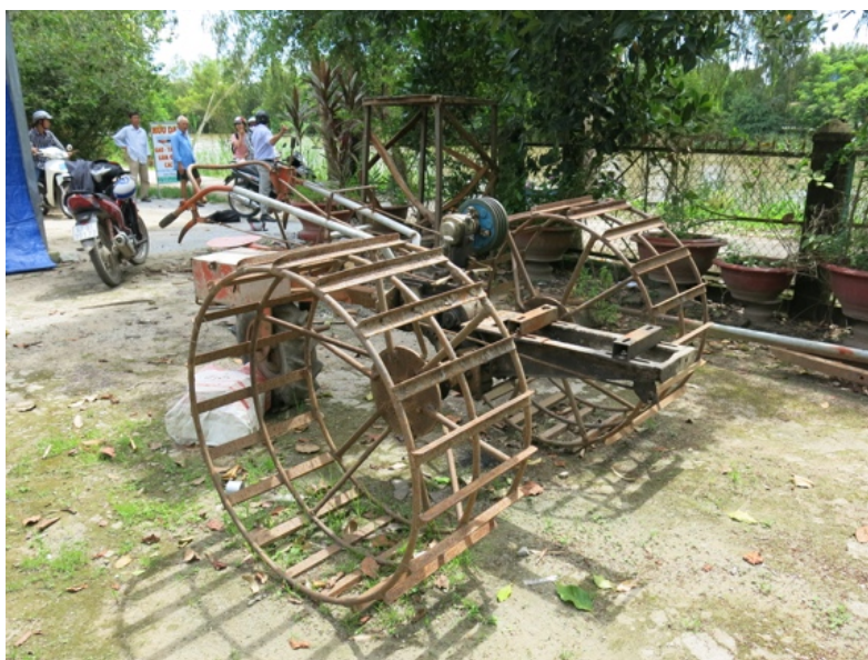
写真3 ほぼ手作りの代掻き用耕耘機（アンザン省トアイソン県、2017年8月）。
