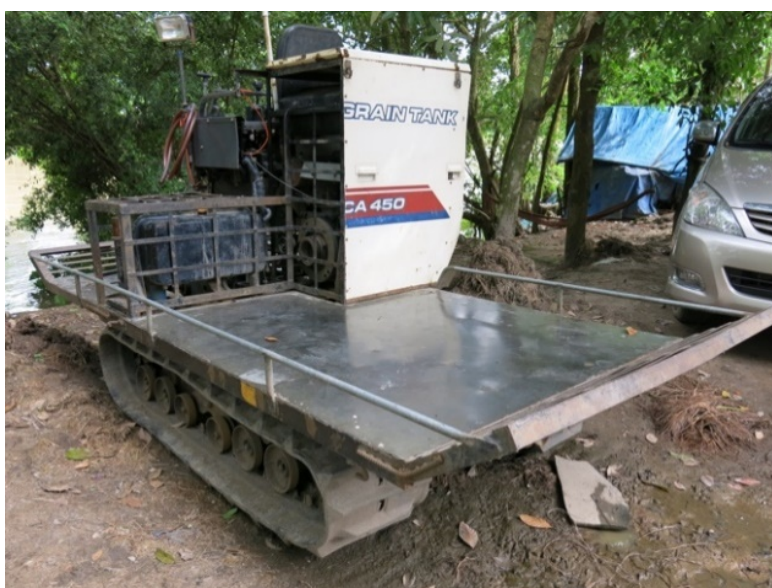
写真2 コンバインを改造した靱運搬車（アンザン省トアイソン県、2013年10月）
