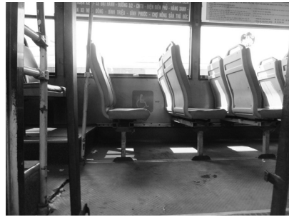
写真 3-10 2017年のベンツ製のバリアフリーバスからは介助機器が取りはずされて、座席が装着されていた。座席の横に国際シンボルマークが残り、入口にはリフトの跡がある (筆者撮影)
