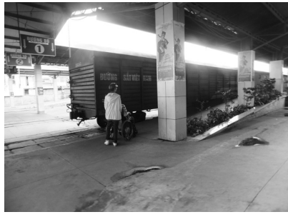
写真 3-5 サイゴン駅ではすべてのプラットフォームが地上からアクセスできる (筆者撮影)
