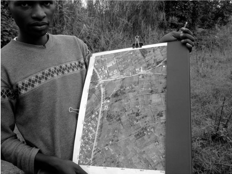
ルワンダの土地権利証書発行作業の一コマ。衛星写真を手にした調査員が現地を回り、どの土地が誰に帰属するのかを確認したうえで、鉛筆で写真上に境界線を引いていく（2011年8月16日筆者撮影）。
