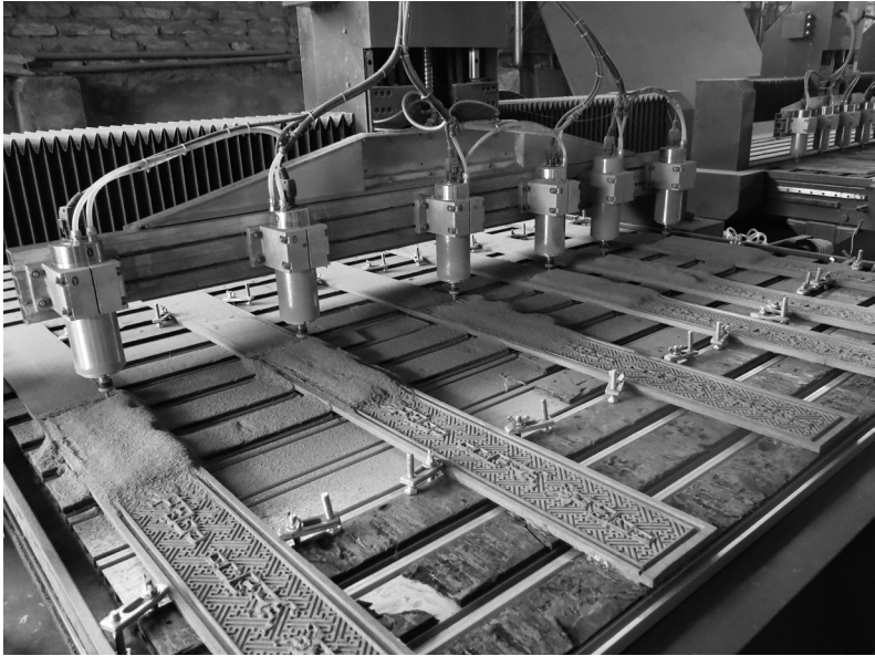
写真2：NC旋盤で彫刻した家具のパーツ。
