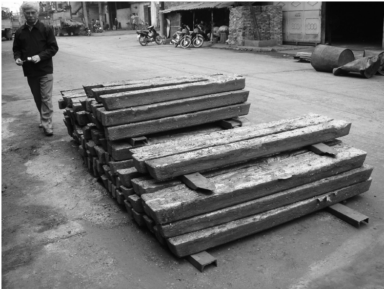
写真2：スクラップから生産されるピレット。これを別の業者が圧延して建設用の棒鋼を製造する。 (2006年12月 筆者撮影)
