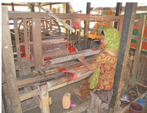
写真6 木製の織機。横糸を巻いた杼(ひ:shuttle)を人力で左右に動かすことによって布を織る(2010年バングラデシュ南部ボリシャル県チョールバリアで撮影)
