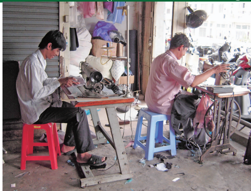
写真10 カンボジアの首都プノンペンの上階で働く仕立て屋さんたち。右のミシンは昔ながらの足踏みミシンだが、左のミシンは工場ですべて使われているような電動ミシン(右足のペダルに注目)である(2009年撮影)
