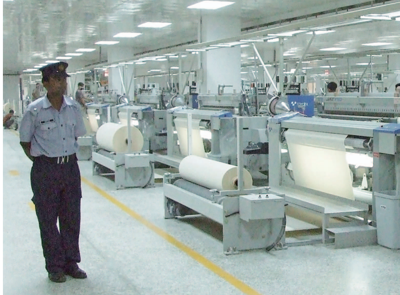
写真7 籽を、空気で動かすことによって布を織るエアジェット織機 (2008年バングラデシュの首都ダカで撮影)
