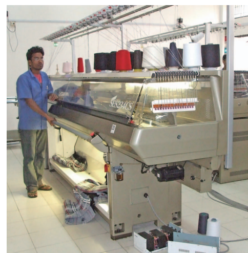
写真9 自動化の進んだ横編み機 (2008年ダカで撮影)
