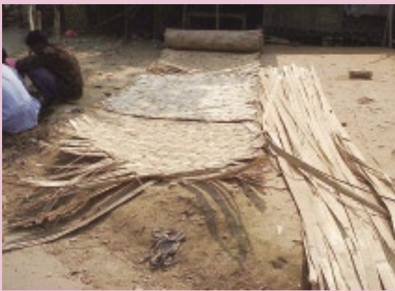
竹を裂いて薄い帯状にする（写真右側）。そしてそれを編みあわせて、目の粗いゴザ状のシートを作る（写真左側）
