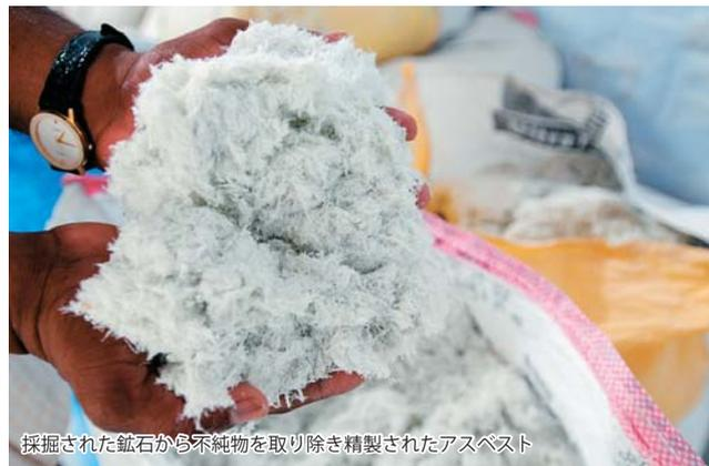
採掘された鉱石から不純物を取り除き精製されたアスベスト
