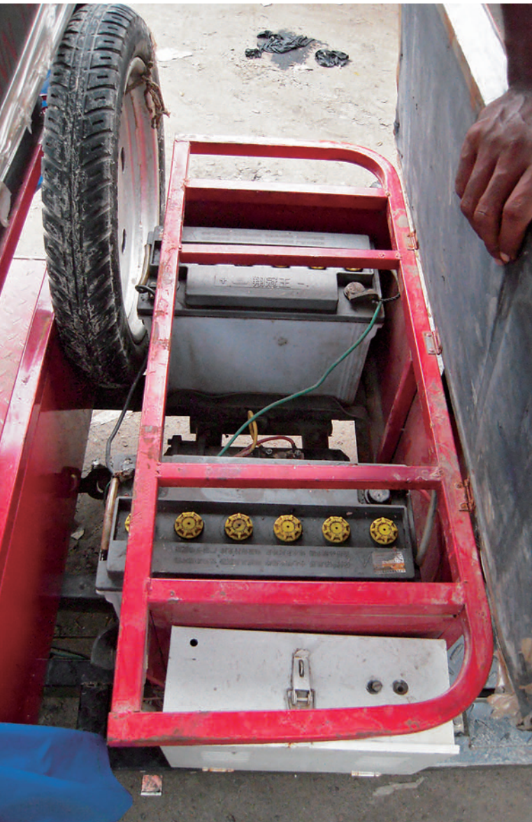
▲運転手の座席の下にバッテリーが2つある。上のバッテリーには、ブランド名と覚しき「翔冠王」の文字が。手前の白いボックスに差し込み口がある
