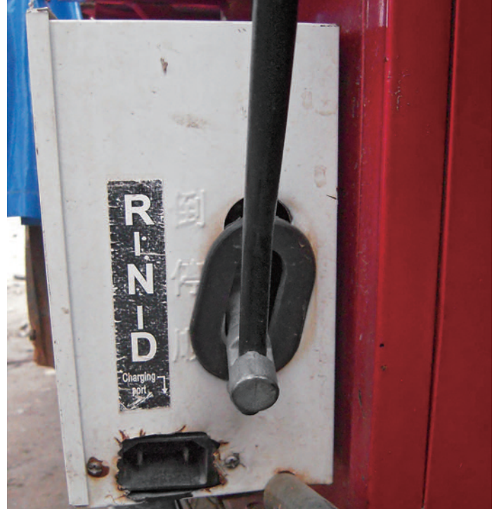
▲白いボックスを拡大して前方から写したところ。「R-N-D」の文字（おそらくRear/Neutral/Driveの略）の下に電気の差し込み口が見える。このボックスは変速機にもなっているようで、R-N-Dの隣にうっすらと「倒停順」の字が見える
