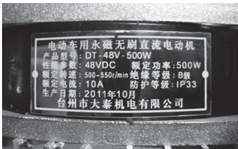
中国から輸入されているモーター部分。バッテリーリキシャの核心部のひとつ
