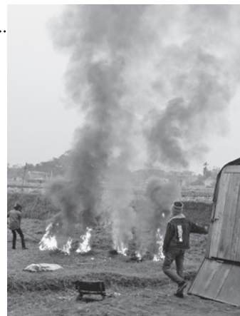
写真2 被覆銅線のプラスチック部分を焼き、銅を取り出す作業（ベトナム・ヴィンフック省にて2011年1月筆者撮影）
