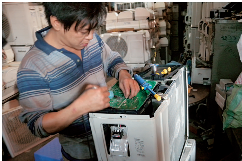
電圧の違いを調整するためにエアコンの部品を 入れ替えている (カンボジア・プノンペン、2013年3月)
