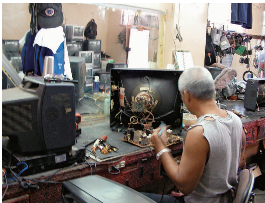
輸入された中古テレビの修理、チューナーの調整、 変圧器の組み込みを行っているところ (フィリピン・マニラ近郊、2007年2月)
