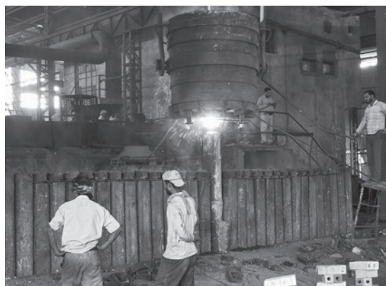
写真2 ペンシルインゴットの鑄型に溶鋼を注入する作業。 ルディアーナーの誘導炉工場にて（2012年10月23日筆者撮影）
