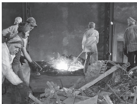
写真1 誘導炉のつばにスクラップを投入する労働者。 ルディアーナーの誘導炉工場にて（2012年10月23日筆者撮影）
