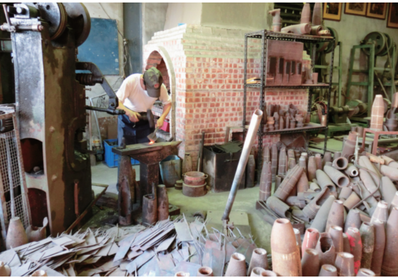
地元で有名な包丁屋の工房—中国から撃ち込まれた砲弾の破片を用いて包丁を作る
