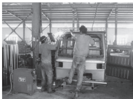
マンダレーのグッド・ブラザーズ。農業用トラクターに載せるキャビンを板金で作っている(2013年8月14日、筆者撮影)
