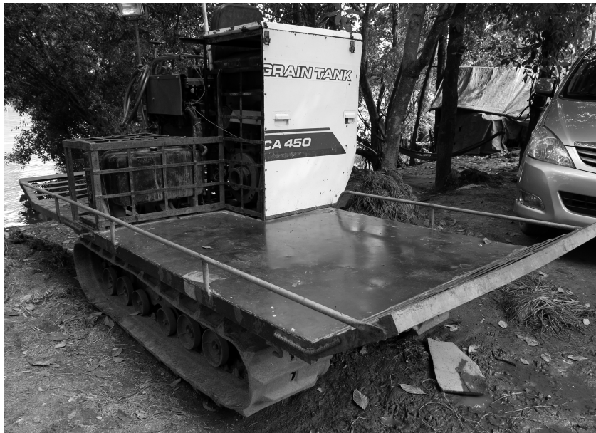
コンバインを改造したコメ運搬車。
