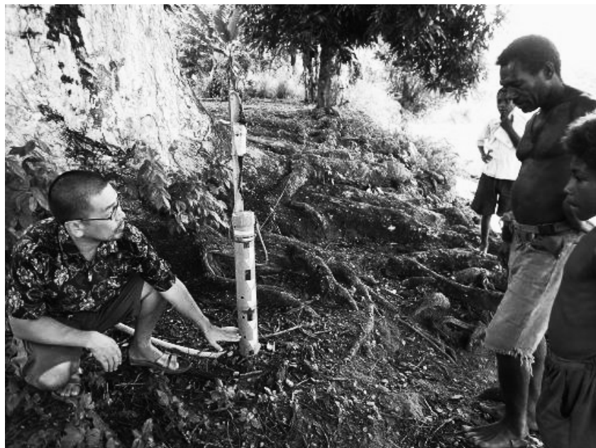
ウマサニ川に設置された簡易水位計（2013年3月筆者撮影）
