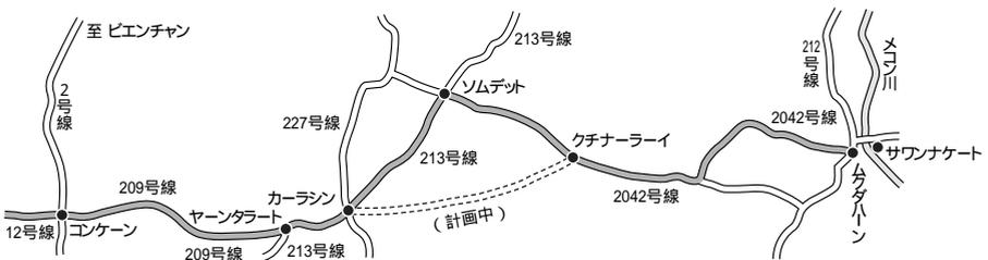
での区間は、3つの2車線の国道を継ぎ接ぎしたようなルートを取っている(図1)。具体的には、クチナーライ経由のムクダハーン - ソムデット間の国道2042号線、カーラシン経由のソムデット - ヤーンタラート間の国道213号線の区間、ヤーンタラートからコンケンまでの国道209号線である。しかし、タイ政府は、将来的にクチナーライからソムデットを通らずにカーラシンまで行ける道路を開発することを計画している<sup>(16)</sup>。なお、東西回廊が開通することで、サワンナケートからは約700km離れたタイのレムチャバン港よりも、約500km離れたダナン港の方が距離的には近くなるが、ベトナム国内の区間は速度制限が厳しく、時速約50km程度の走行を余儀なくされ、時速80kmから100km走行が可能なタイと比べ、より多くの時間を要する。
