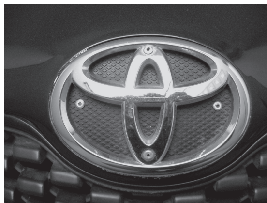
写真2 メーカーのエンブレムをリベットで固定して盗難を防止する。(筆者撮影)
