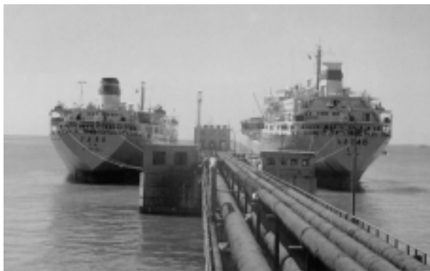
中国の製造した代表的なタンカー「大慶」（最大10万トン）。写真は、国内南部の製油所に大慶油田からパイプラインで輸送された大慶原油を転送するために秦皇島のオイルバースで原油積み込み中の「大慶」44と245号（『中国石油産業1949-1989』より）
