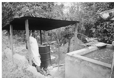
写真⑫ 気化したアルコールは細い管を通り、水槽の中で冷却される。
