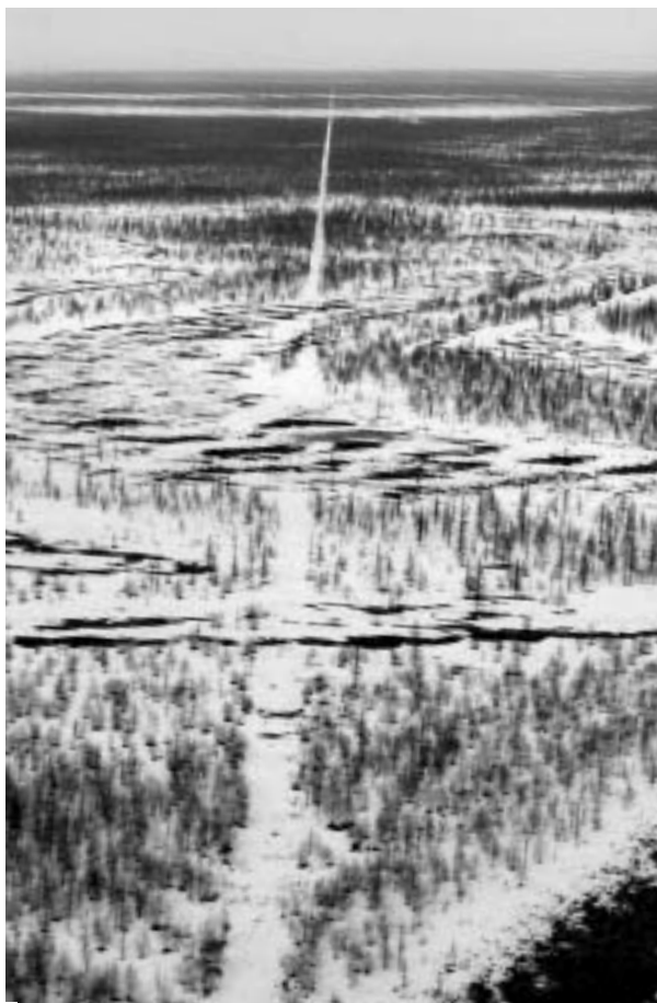
シベリアの原野に延びる一本の真っ直ぐな白線。当時の地震探鉱の測線の跡である。ナディム市の北方にて。(筆者撮影)
