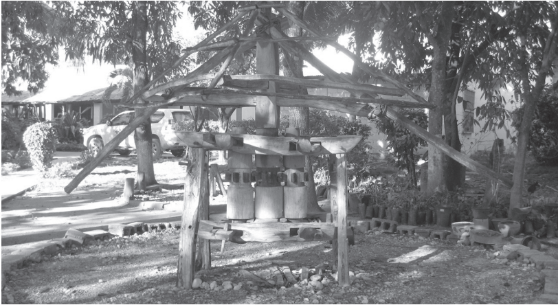
サトウキビから汁を搾り出す機械の展示（ハイチ農村），家畜を使って動かしていたもの（2015年筆者撮影）
