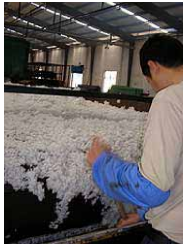
輸入された廃ペットボトルから製造された綿。
