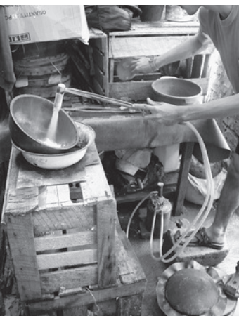
写真1 携帯電話の基板から金を取り出す作業。台所のすぐ脇のスペースで行われていた。（インドネシア・バンドンにて2010年9月筆者撮影）
