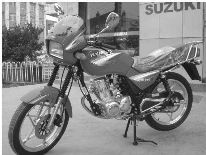
写真2 中国のモーターサイクルの例（台湾の光陽工業の在中国現地関連会社モデル。エンジンはCG125の、ボディはGS125のマイナーチェンジ版）
