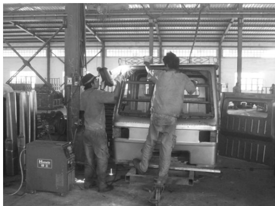
農業用トラクターに載せるキャビンを板金でつくっている。 (2013年8月14日、筆者撮影)
