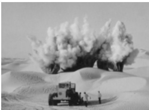
タリム盆地（タクラマカン砂漠）における地震探 査のダイナマイト爆破作業は今日でも絶え間なく 続く（『中国石油工業』より）
